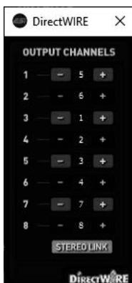
上図の例では、再生チャンネル 5/6 が物理出力 1 および 2 に、再生チャンネル 1/2 が物理出力 3 および 4 に、再生チャンネル 3/4 が物理出力 5 および 6 に、再生チャンネル 7/8 が物理出力 7 および 8 に割り当てられています。これらは、STEREO LINK を有効にして設定されています。
