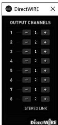
この設定では、すべての物理出力チャンネルペアが、再生チャンネル 1/2 の信号を出力します。オーディオアプリケーションからのステレオ再生チャンネルを、すべての物理出力に“クローン”する場合のセットアップです。
