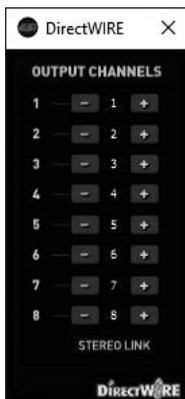
ウィンドウには、8系統の出力チャンネルがリスト表示されます。左の列は、GIGAPORT eXの物理出力を示します。右の列は、コンピューターの再生チャンネルを示します。たとえば、この列の値1および2は、チャンネル1/2の信号が再生されることを意味します。デフォルトでは、再生チャンネル1（右）が物理出力1（左）、再生チャンネル2が物理出力2に割り当てられています（以下同様）。
